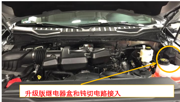
图2：upfitter继电器盒和upfitter开关钝切输出位置。
